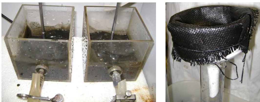
Figura 44 - Lodo em mistura após a adição de polímero orgânico (esquerda) e funil de Buchner e proveta utilizados (direita)
