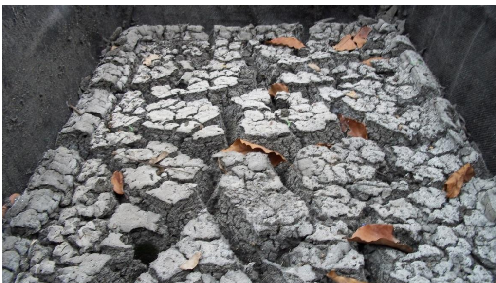
Figura 83 - Aspecto do leito de drenagem ao final do ciclo de secagem do E11
