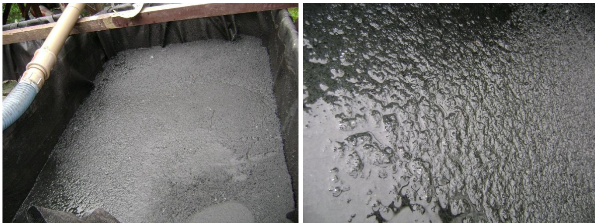
Figura 114 - Alimentação do leito de drenagem com lodo condicionado ( D_c = 2 \text{ g/kgST} e Ca = 14,57 \text{ kgST/m}^2 )
