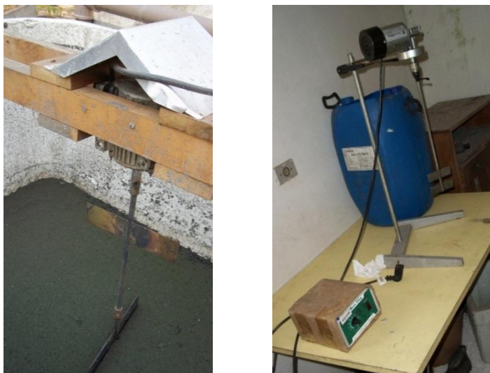
Figura 49 - Tanque de condicionamento com o motor e as pás do misturador (esquerda) e recipiente de preparo de polímero e misturador (direita)
