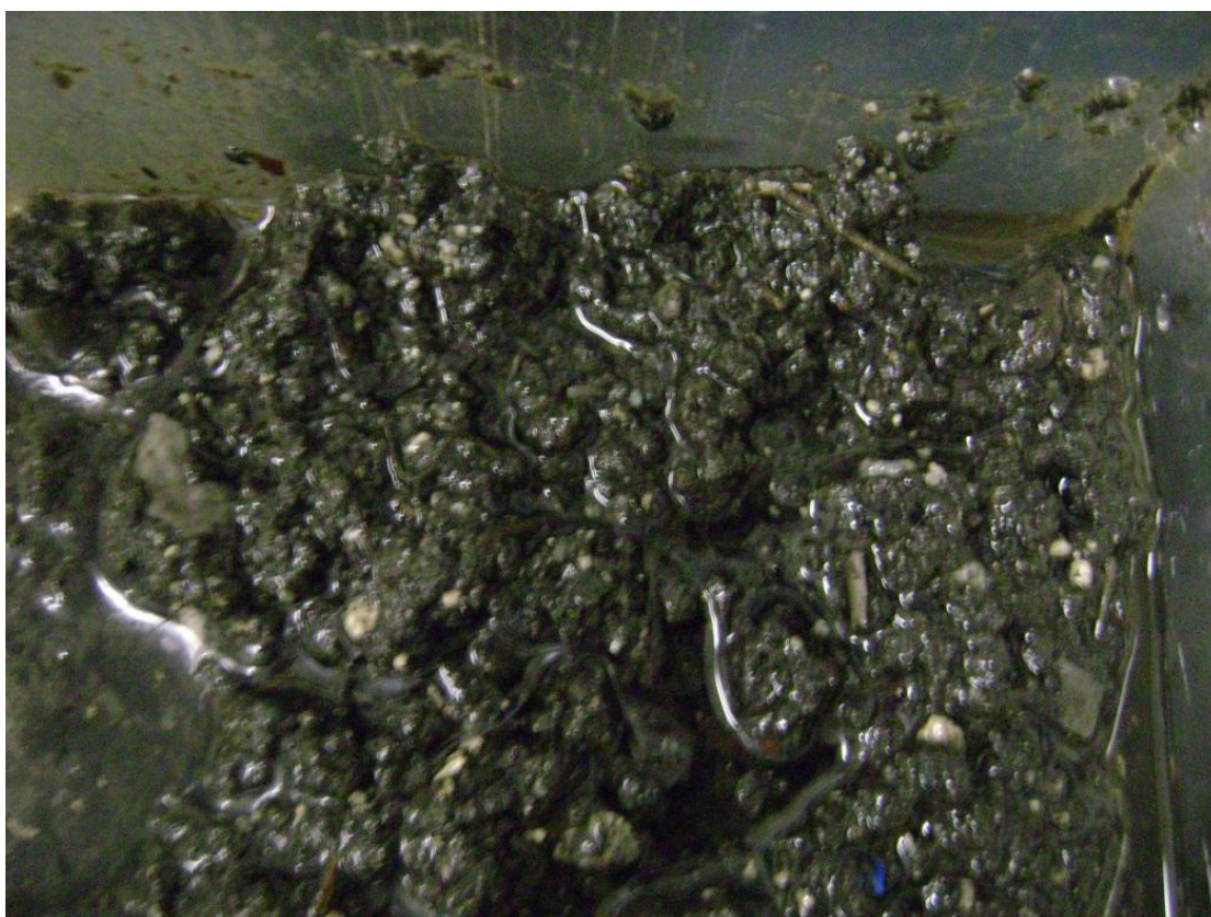
Figura 64 - Aspecto do lodo condicionado com aumento significativo do percentual de água livre e formação de flocos estruturados
