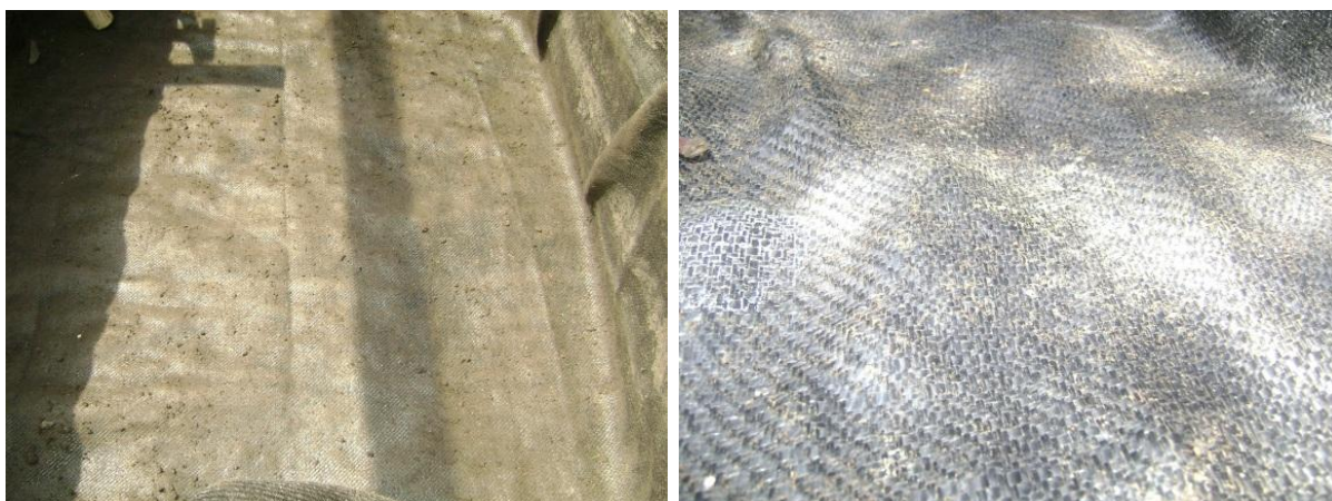
Figura 76 - Aspecto da manta após a remoção manual da torta de ensaio sem condicionamento à esquerda (E9) e com condicionamento à direita (E10)
