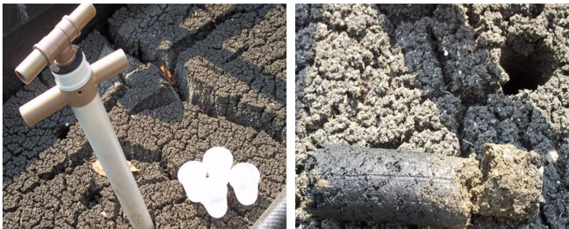
Figura 53 - Amostrador, recipientes de coleta e amostra retirada da torta
