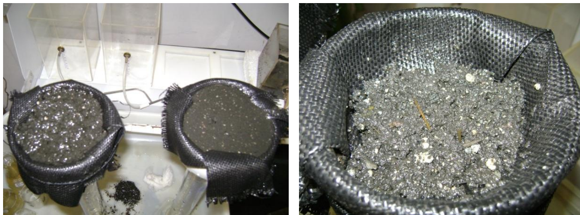
Figura 46 - Amostras de lodo condicionado em processo de desaguamento no laboratório (esquerda) e aspecto da torta formada (direita)
