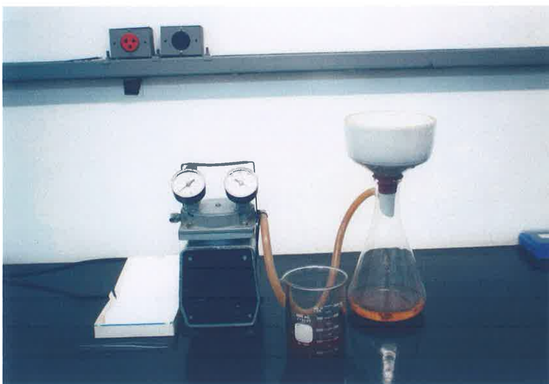
Figura 4.9 – Equipamento para Filtração do Lodo Acidificado
