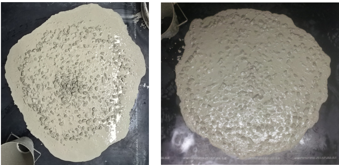
Figura 72 - Ensaio de espalhamento (flow-test) após o primeiro ciclo de cisalhamento (esquerda) e após o segundo ciclo (direita), evidenciando a mudança na tendência de separação de fases. O tempo entre os ensaios é de cerca de 20 minutos.
