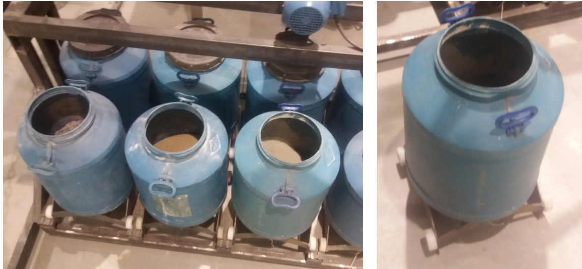
Figura 106 - Sistema de alimentação do misturador instrumentado: vista superior parcial da bateria de mini silos (esquerda) e detalhe de um mini silo individual, o qual é removível para preenchimento e pesagem (direita).
