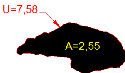
Figura 113 - Partícula de um grão de agregado de granito analisado com Camsizer® (unidade de dimensão: mm)
