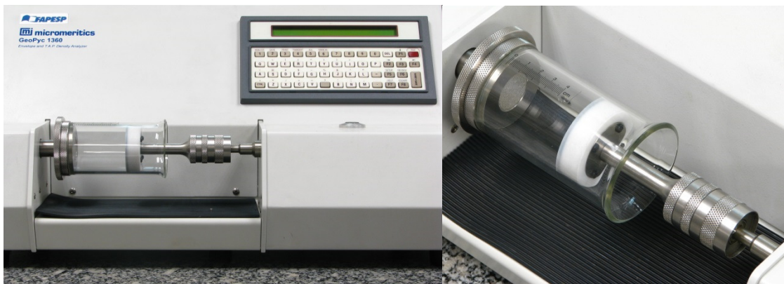
Figura 7 – Equipamento para medida do empacotamento experimental (GeoPyc 1360): vista frontal (esquerda) e detalhe da célula de 50,8 mm com êmbolo (direita)
