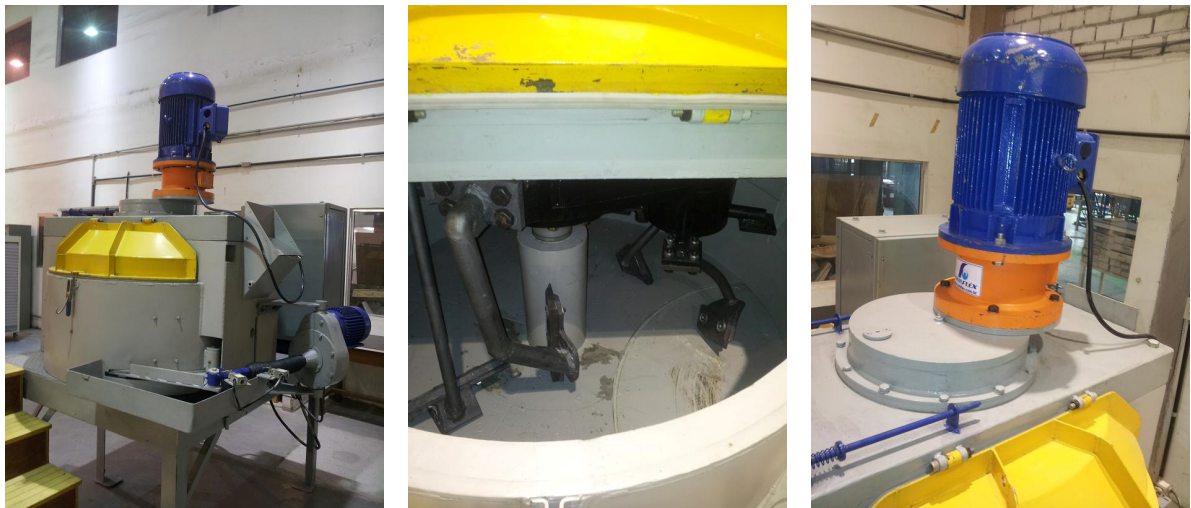
Figura 104 - Misturador de concreto reformado e instrumentado: visão geral (esquerda), vista interna (centro) e detalhe da célula de torque, instalada entre o motor e o redutor do misturador (peça laranja - direita)
