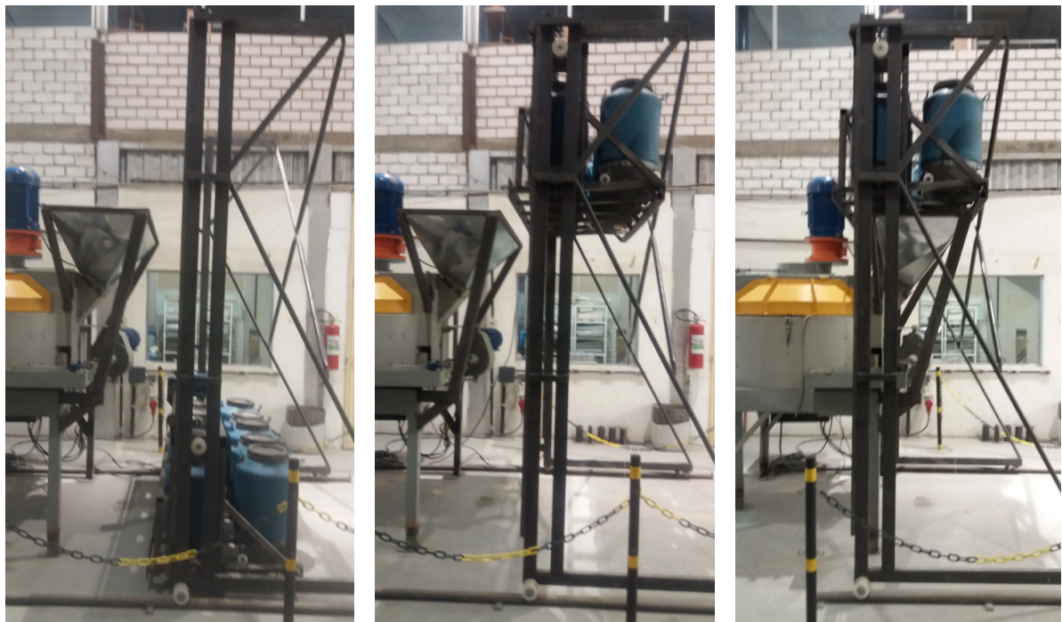
Figura 107 –Vista lateral da sequência de posicionamento para descarga: bateria de silos posicionados ao nível do solo (esquerda), bateria de silos na posição elevada (centro) e descolamento horizontal para posicionamento acima do funil de descarga (direita).
