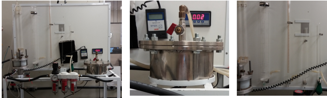
Figura 123 – Equipamento de medida de permeabilidade ao ar. Visão geral (esquerda), detalhe da câmara de pressão onde se insere a fatia de concreto (centro) e bolômetros de diversos calibres para medidas de permeabilidade em diferentes ordens de grandeza (direita)
