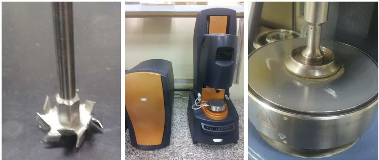
Figura 53 - Ensaio de reologia de pasta: misturador cowles usado para dispersar a pasta em alta rotação (esquerda); reometro DHR-3 (centro); geometria de placa paralela (direita)
