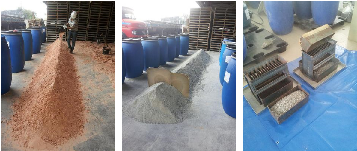
Figura 48 – Procedimento de quarteamento: deposição do material na pilha alongada (esquerda); seccionamento da pilha (centro); quarteamento secundário com quarteador tipo Jones (direita).
