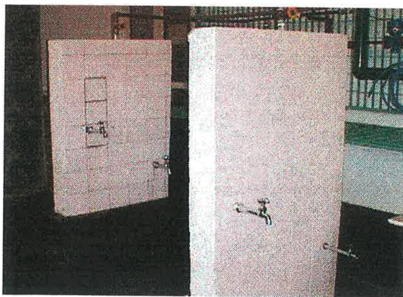
Figura II.3 – Painéis hidráulicos preparados para o ensaio de vazamento.
