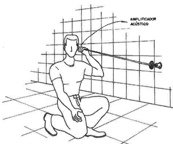
Figura 5.8 – Detecção de vazamento com haste de escuta.
