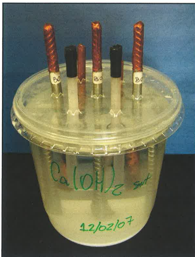
Figura 4-13 – Corpo-de-prova utilizado para avaliação da resistência à corrosão dos sistemas de reparo em meio aquoso.
