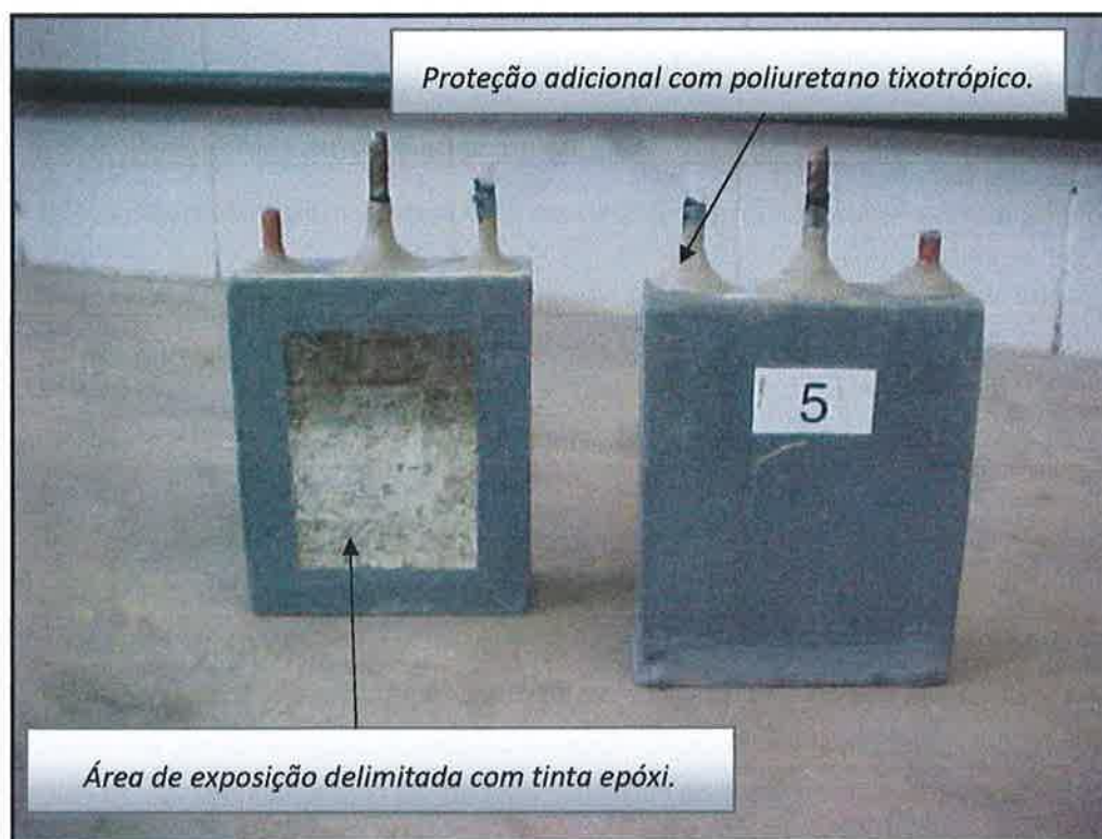
Figura 4-12 – Detalhe do corpo-de-prova pronto para iniciar os ciclos de contaminação acelerada.
