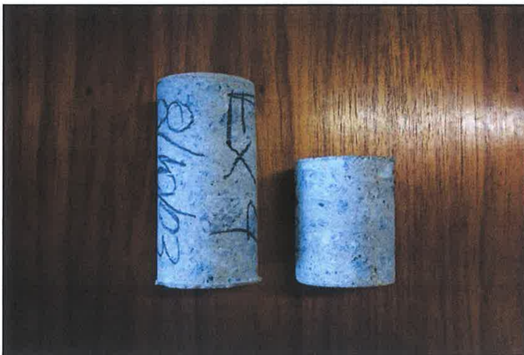
Figura 3-10 – Detalhe dos testemunhos extraídos.
