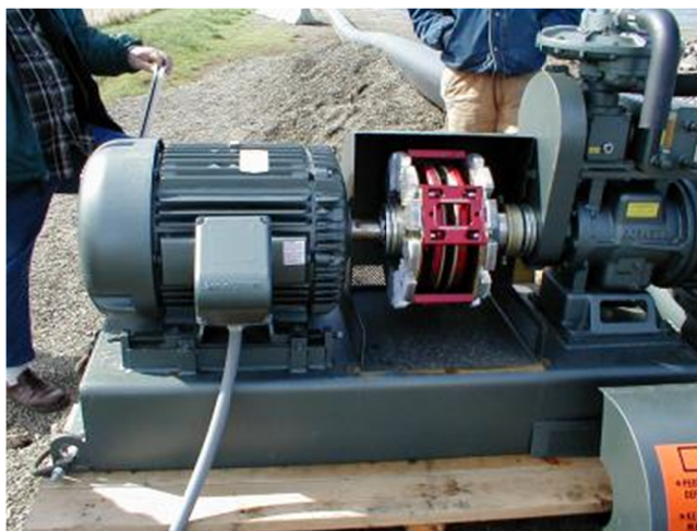
Figura 1.2 – Exemplo de aplicação do acoplamento magnético: bombas para irrigação [32]
