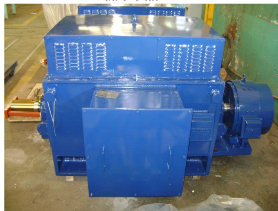
Figura 9 - Gerador com excitatriz em separado
