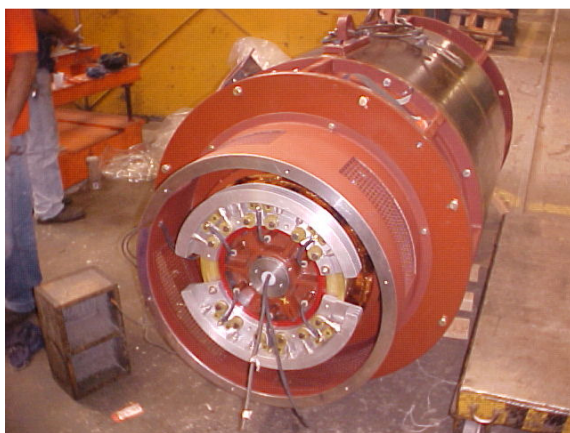
Figura 6 - Gerador com excitatriz “brushless” acoplada
