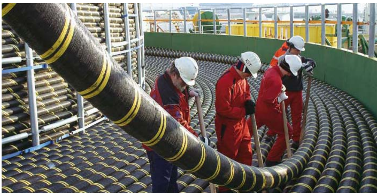
Figura 3 – Relação dimensional entre operários e um cabo umbilical (ABB, 2009)
