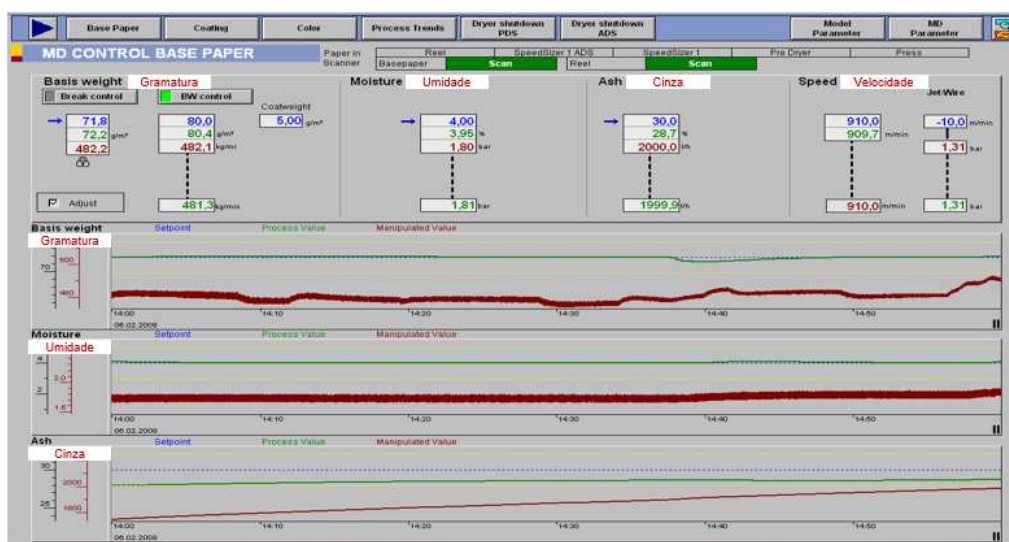
Figura 42 - Tela de interface de controle longitudinal do papel
