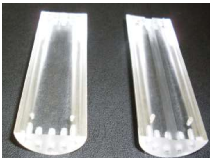
Figura 27 – Fotos do suporte do de acrílico de acondicionamento dos Cristais a) aberto, b) fechado e c) com os cristais posicionados.
