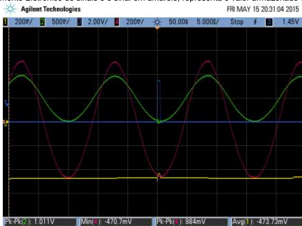
Figura 74 – Forma de onda proveniente da célula recuperadora (cor verde) e o sinal eletro-óptico na malha interna do detector de vale (cor magenta) sem sinal de alta tensão aplicada ( vales em equilíbrio ). (O sinal, de cor azul, mostra os pulsos de sincronismo interno da Unidade de Processamento Eletrônico de sinais e o sinal em amarelo, representa o valor armazenado do vale).
