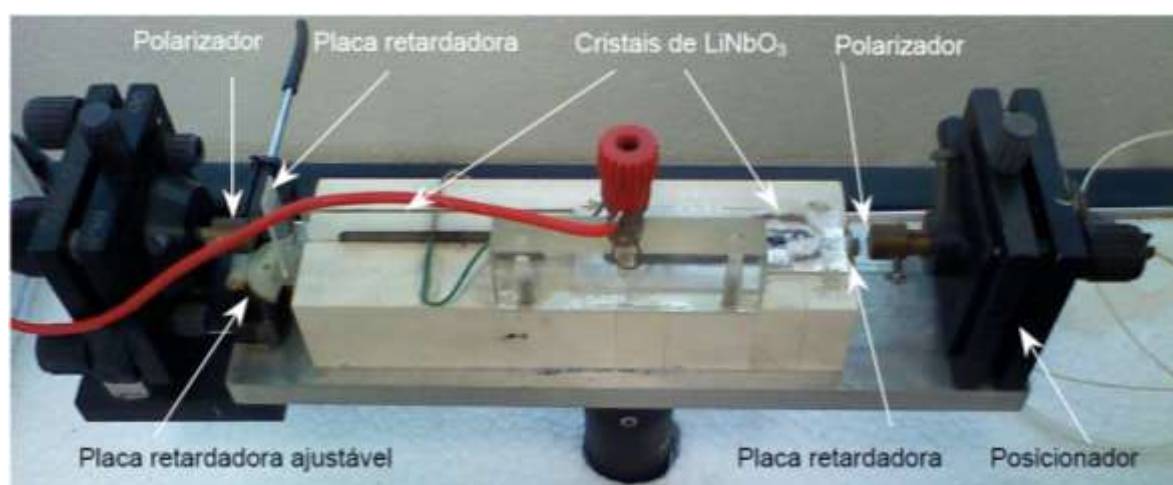
Figura 36 – Interferômetro recuperador volumétrico construído
