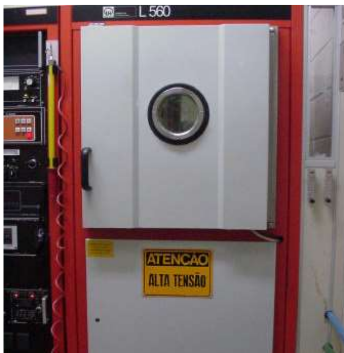
Figura 32 – Evaporadora LEYBOLD L-560 utilizada no processo (PVD).
