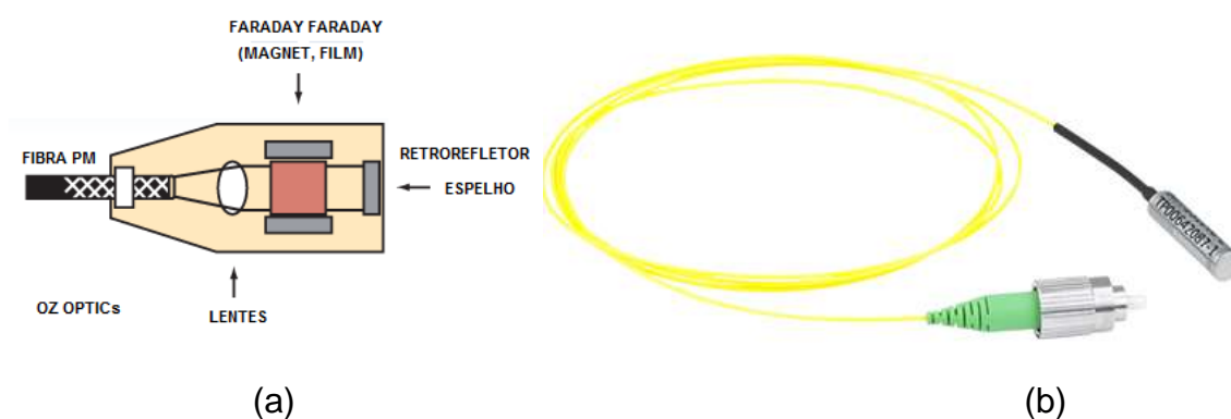
Figura 47 – a) Desenho ilustrativo de um Faraday Mirror , b) Foto do componente da OZoptics.
