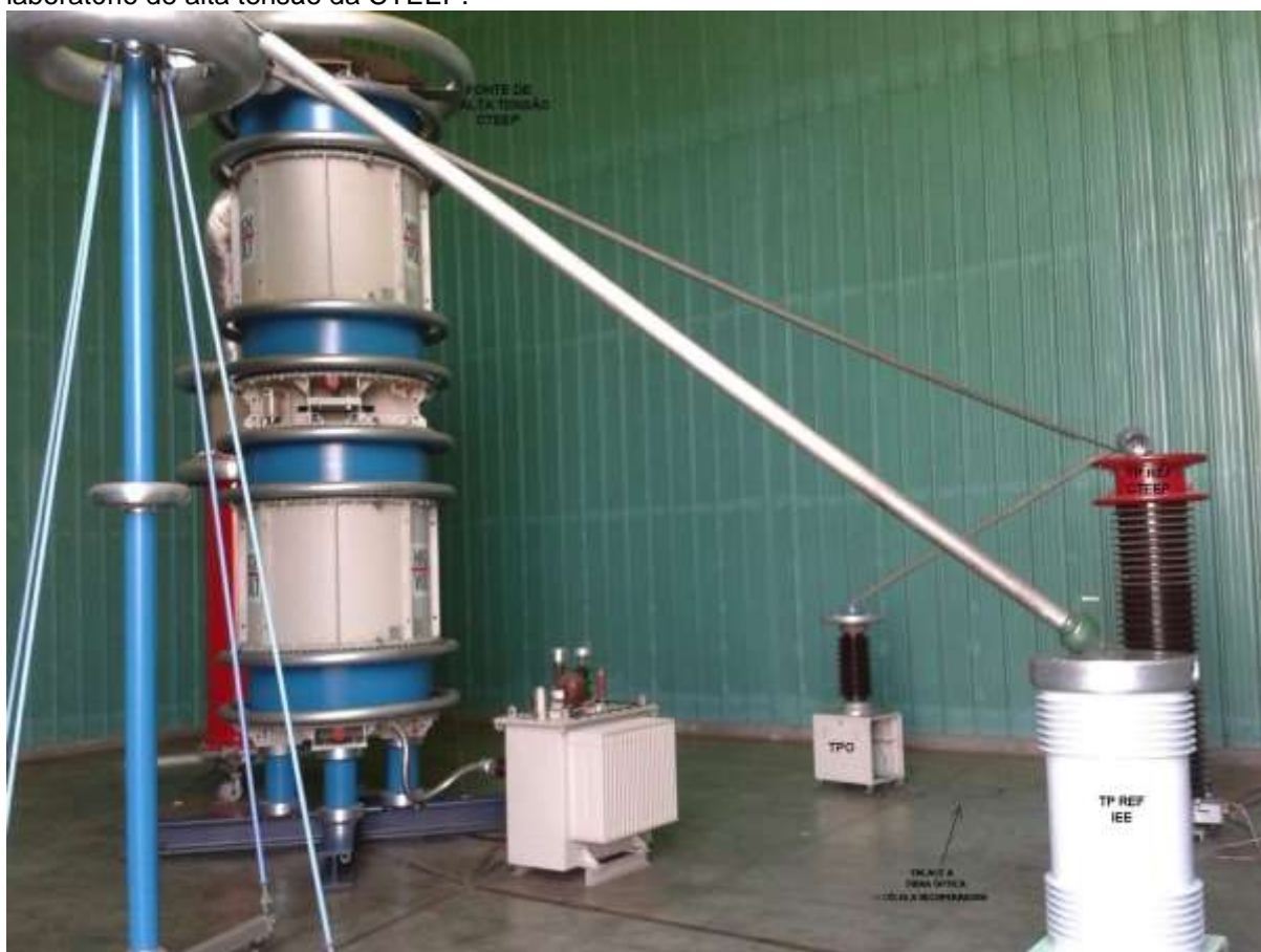
Figura 72 – Foto do arranjo utilizado para os ensaios do protótipo de TPO nas instalações do laboratório de alta tensão da CTEEP.
