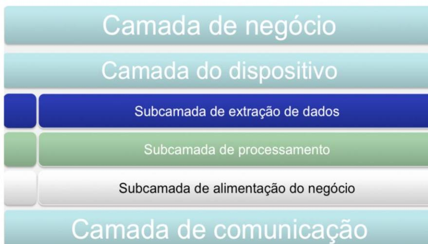
A camada de negócios contempla os atores envolvidos e suas respectivas atividades. A camada do dispositivo, e suas três subcamadas, definem os componentes do equipamento SAT (*hardware*) que permitirão a extração de dados, os processamentos que serão realizados e os protocolos para alimentar o órgão de controle. Por fim, a camada de comunicação define os tipos de conexão e estrutura de criptografia capazes de transportar e proteger os dados durante a transmissão.
