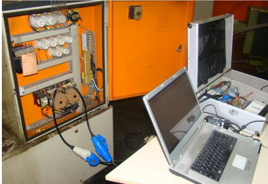
Figura 3.26 Conexão do sistema de aquisição de dados do motor de indução ao sistema de acionamento do torno do LFS.
