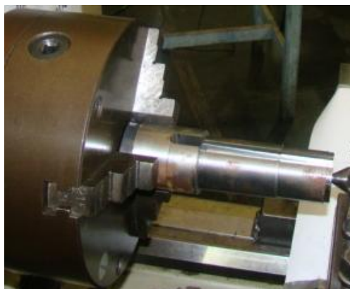
Figura 6-22 Tarugo utilizado para a usinagem com corte interrompido
