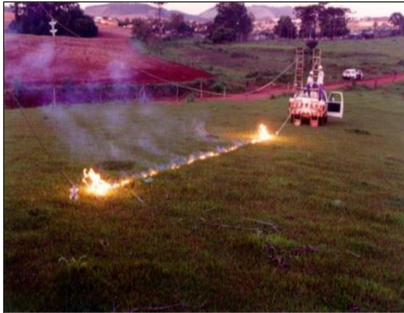
Figura 11 – Curto circuito fase terra – terra, baixa RF
