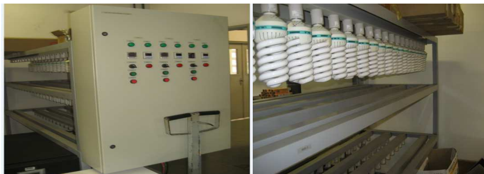
Figura 12 - Ilustra a bancada de testes montada no Laboratório de Fotometria do IEE Fonte: Imagem do Laboratório do IEE-USP
