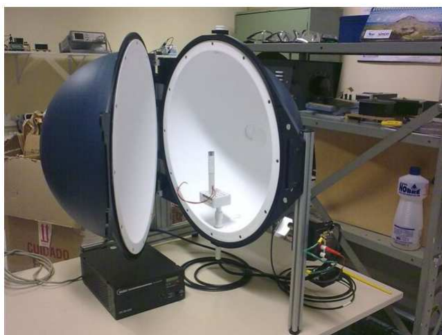
Figura 11 - Esfera integradora Fonte: www.ufjf.br
