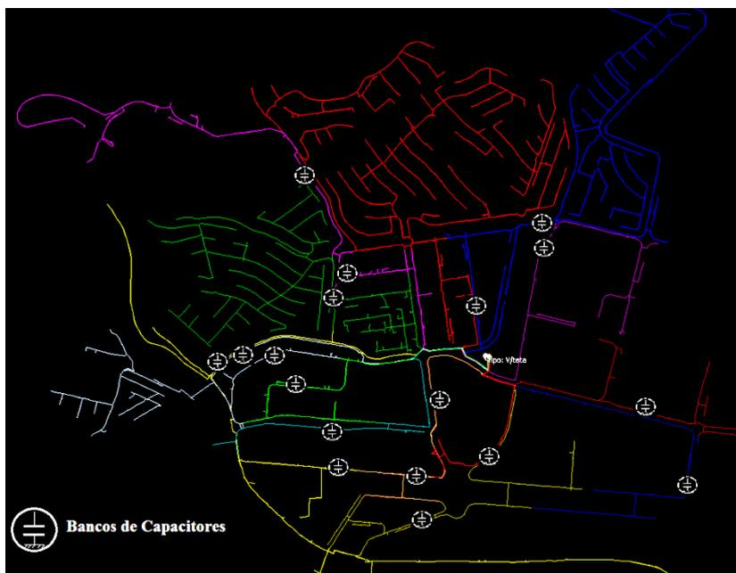
Figura 5-15. Diagrama Unifilar dos Alimentadores e BCs da rede real
