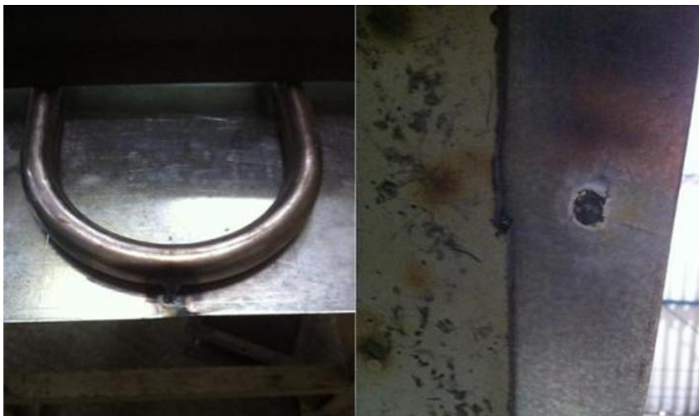
Figura 65 - Junção Chapa-Tubo por soldagem tipo MIG de teste.
