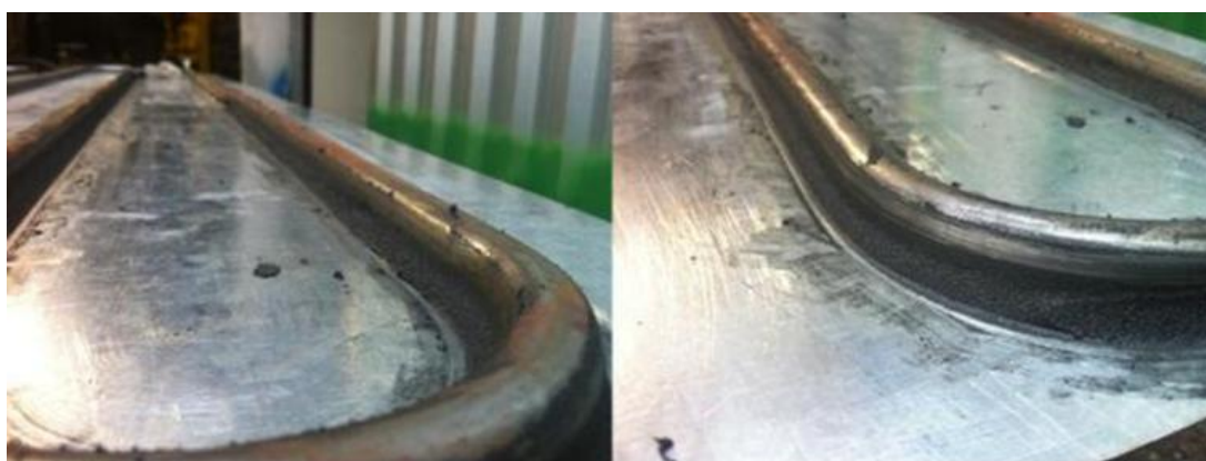
Figura 69 – Modelos de UMAr após receberem aplicação de pasta epóxi condutoras.
