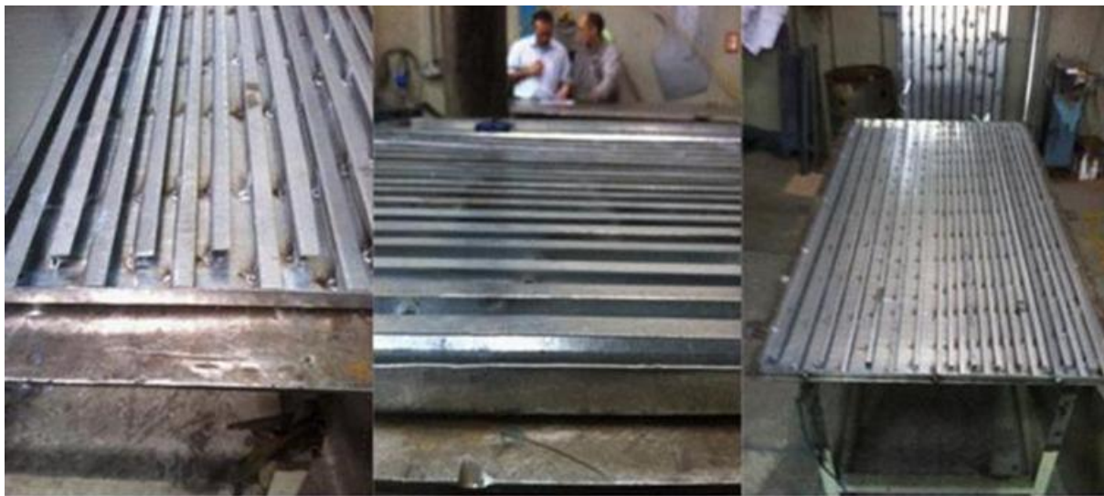
Figura 72 – Dutos fixados na chapa.
