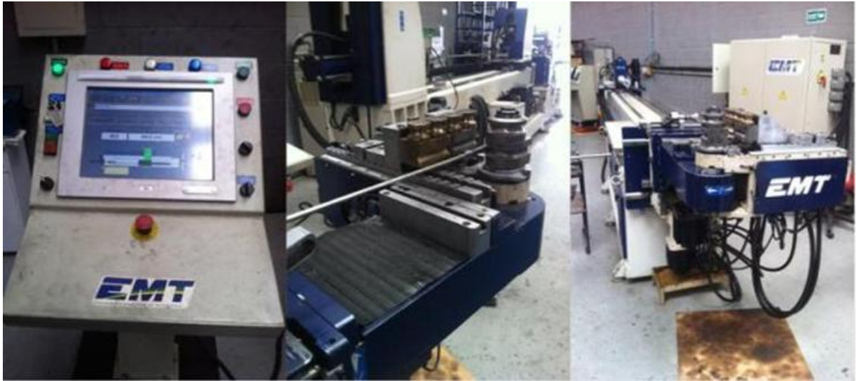
Figura 61 - Dobradeira automática a frio utilizada na produção das serpentinas dos dois modelos do tipo chapa-tubo.
