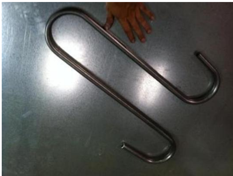
Figura 60 - Tubo de aço carbono DIN 2394 após teste de dobragem
