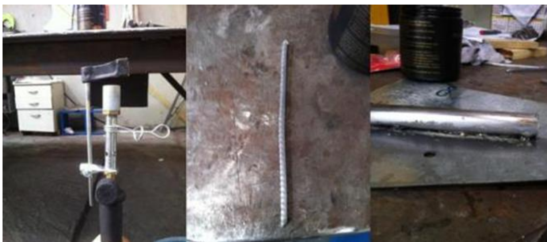
Figura 67 – Maçarico, filamento de estanho e acabamento da deposição de material.
