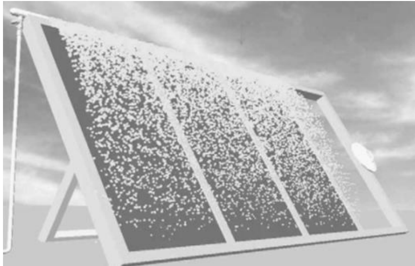
Figura 15 – Representação de um módulo PV com um sistema de arrefecimento da superfície. Fonte: Abdolzadeh et al. , 2009.
