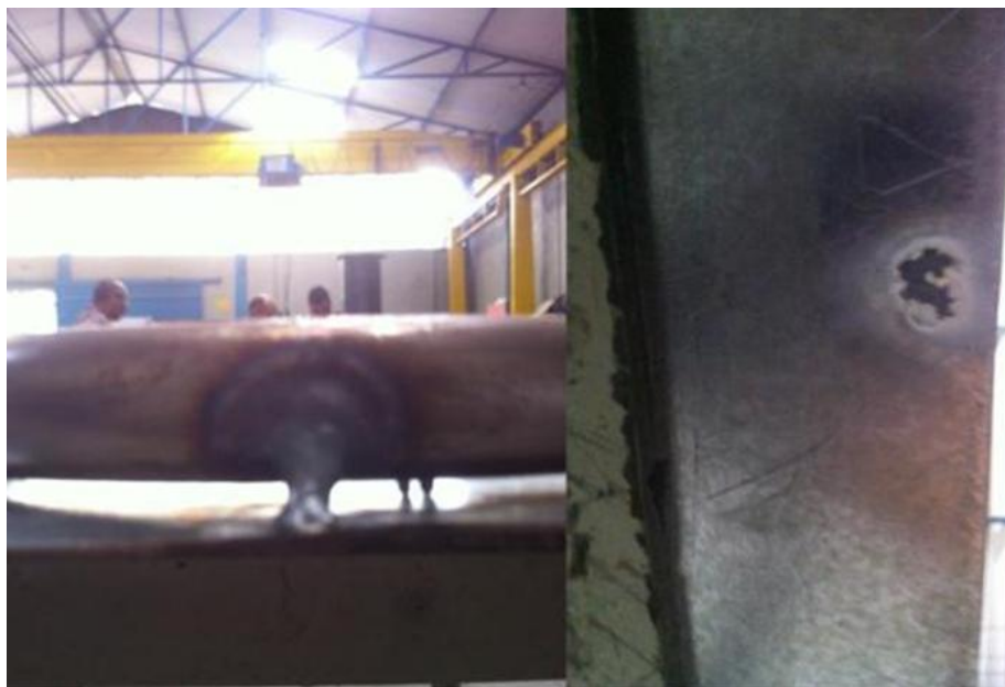
Figura 64 – Junção Chapa-Tubo por soldagem tipo TIG de teste.
