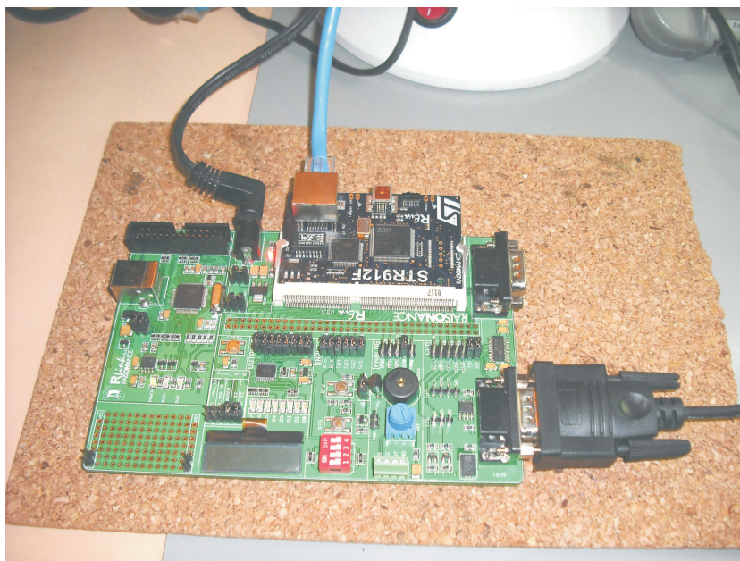
Figura 29: Kit de desenvolvimento com processador ARM9 STR912 da STMicroelectronics, executando o framework “TB” desenvolvido.
