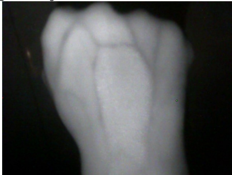
Figura 3 - Imagem de uma mão obtida com filtro IR de 850nm
