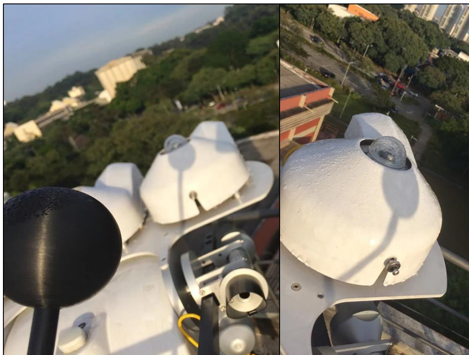
Figura 66 - Registro fotográfico da esfera de sombreamento desalinhada
