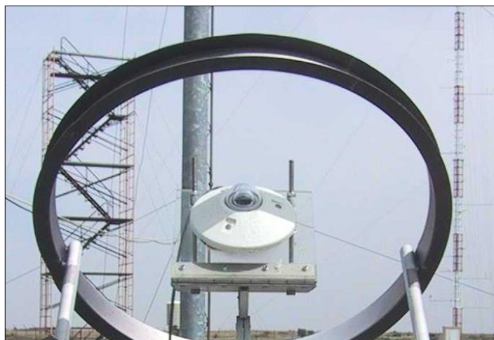
Figura 10 - Piranômetro com banda de sombreamento fixa
