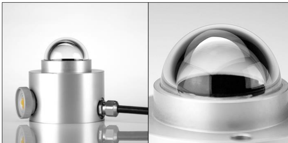
Figura 7 - Piranômetro com sensor enegrecido
