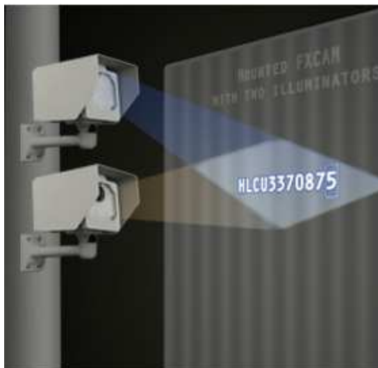
Figura 4 - Exemplo de um leitor capturando o número do contêiner por equipamento de OCR. Fonte: OCRTech.com, 2013.
