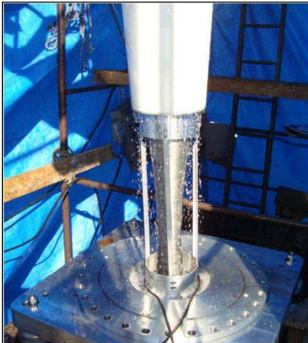
Figura 73 - Cone defletor finalizado recebendo banho de óleo LAB.
