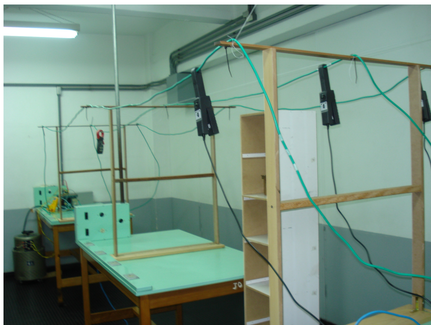
Figura 14 – Linha experimental trifásica e medição das correntes por “probes”
