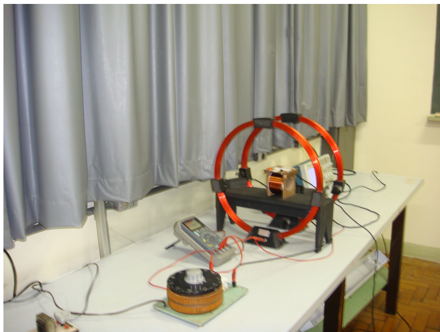
Figura 4 – Foto do circuito de calibração da bobina sonda
