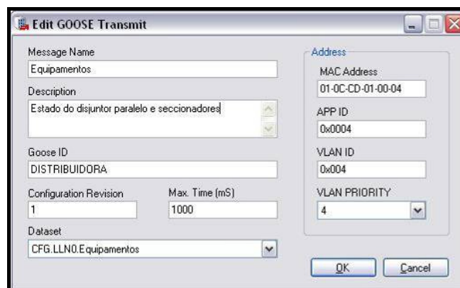
Figura 57 – Configurações para publicação do GOOSE com o data set dos estados dos equipamentos
