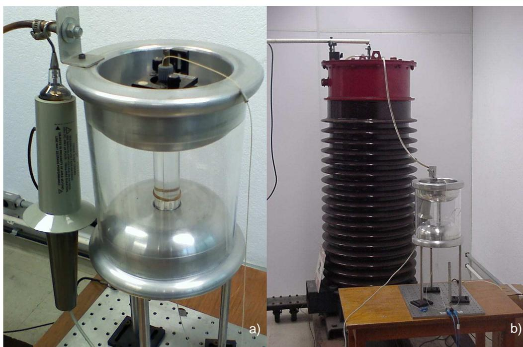
Figura 38 - a) Célula eletro-óptica de alta tensão e b) Célula de alta tensão e transformador de potencial.
