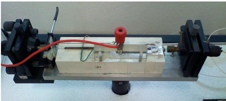
Figura 27 - Modulador eletro-óptico de birrefringência volumétrica.
