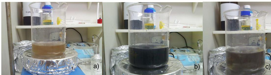
Figura 30 - Processos principais da preparação da solução de Prata. (a) O reagente de Tollens. (b) Hidróxido de Sódio adicionado ao Reagente de Tollens. (c) A solução final com aspecto de “chá fraco” após adição de Amônia.
