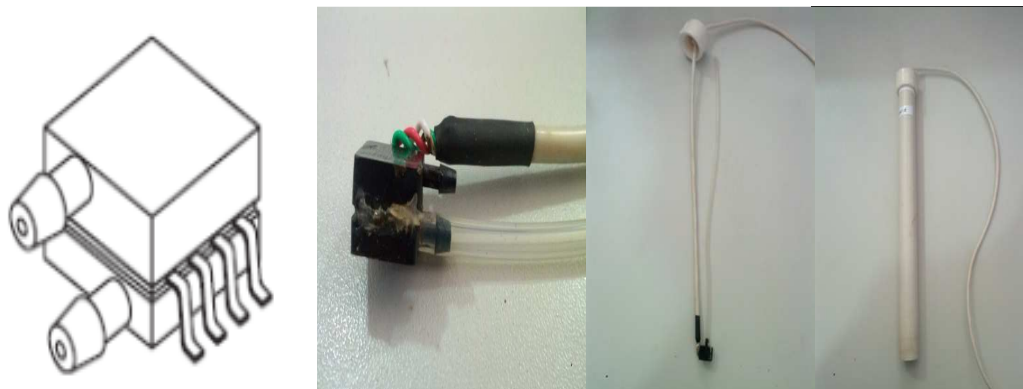
Figura 8 - Sensor tipo MENS código MPXV7002
