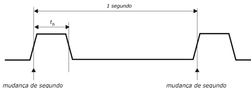
Figura 41 - Forma de onda, no padrão 1pps, gerado pelo dispositivo que define a base de tempo
