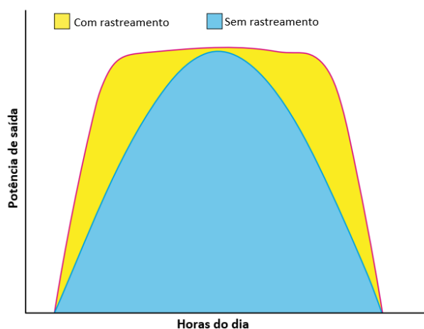
Figura 40 – Diferença da potência elétrica gerada devido ao tipo de estrutura.
