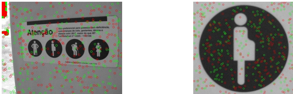
Figura 2.5 Extremas (pontos chaves) achadas utilizando DoG . Aplicação implementada utilizando a biblioteca ProEikon (KIM, H. Y., 2010c) e SIFT disponível em LOWE (2010).
