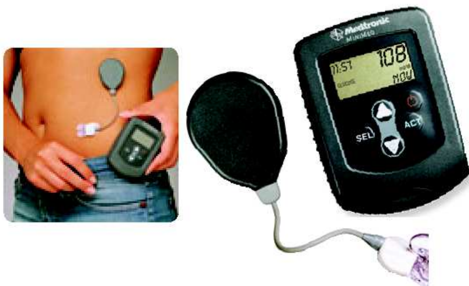
Figura 2.16 - MiniMed Guardian RT - Sucessor do CGMS, este sistema possui comunicação sem fio entre o sensor e o monitor, além de apresentar leituras de glicemia em tempo real (imagens de divulgação)
