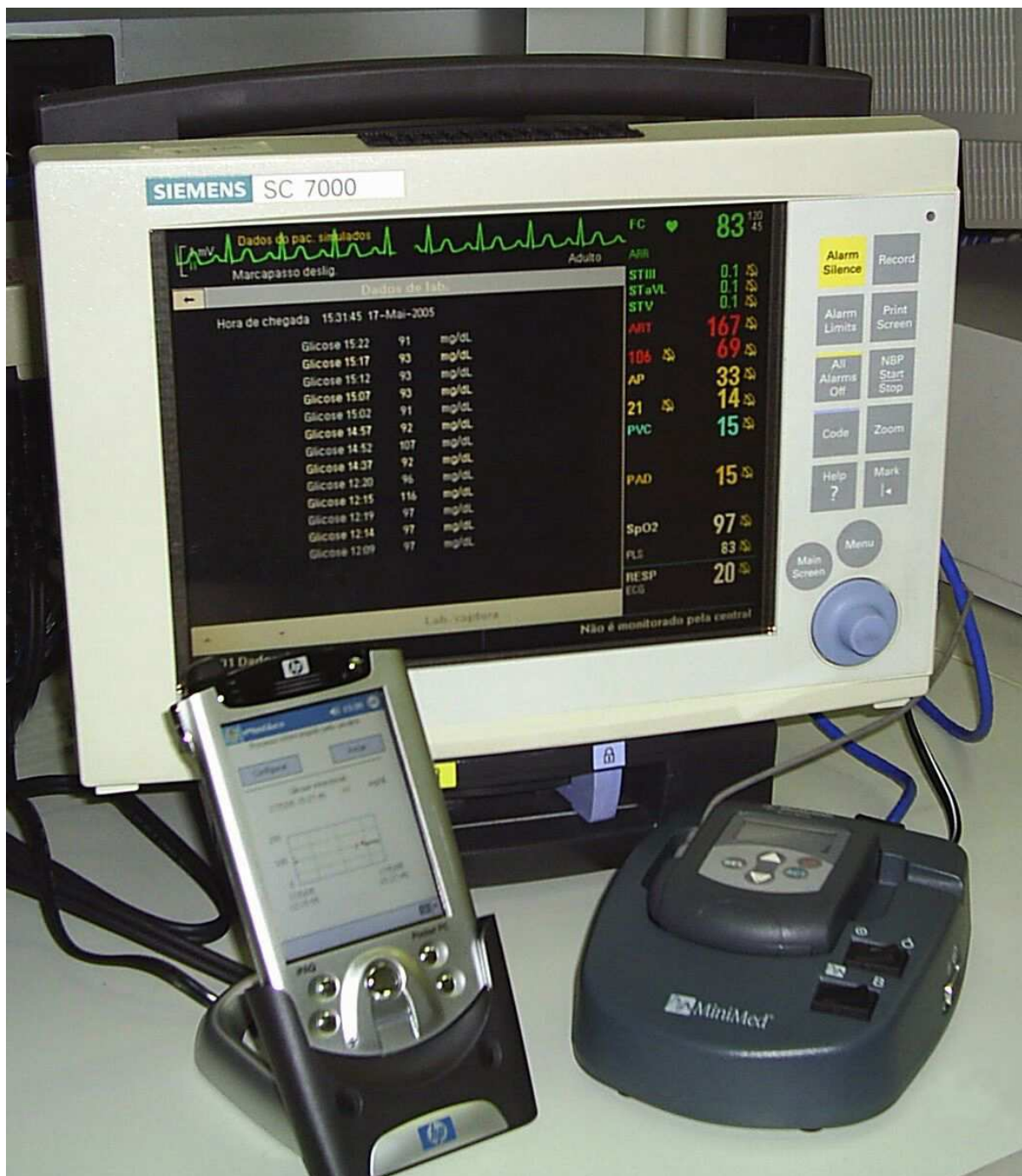
Figura 4.7 – O sistema funcionando em uma bancada de testes. Embaixo, à direita, vê-se o MiniMed CGMS gerando leituras simuladas de glicemia. Embaixo, à esquerda, está o palmtop com o programa vMonGluko Client . Ao fundo, o monitor de beira de leito exibe as leituras de glicemia na forma de uma tabela.
