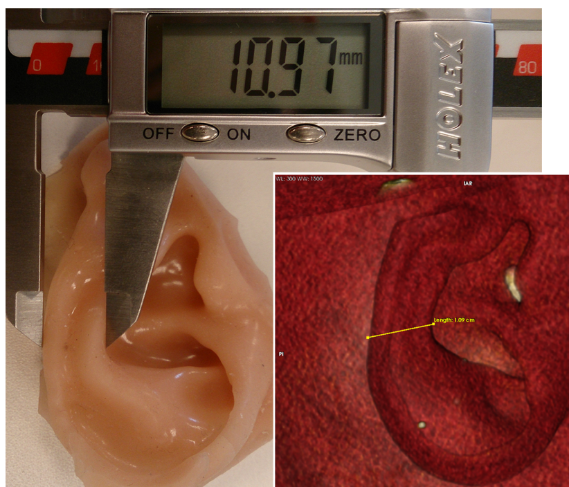
Figura 50: Comparação métrica entre a prótese obtida e a reconstrução volumétrica, primeiro ponto.
