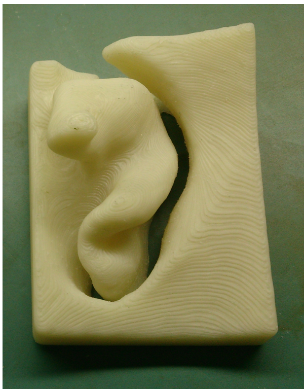
Figura 28: Desníveis inerentes ao processo de Manufatura Aditiva por camadas
