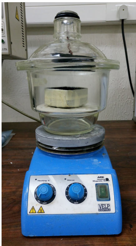
Figura 29: Disposição do ambiente para suavização superficial, composto por um dessecador hermético disposto sobre uma mesa aquecedora
