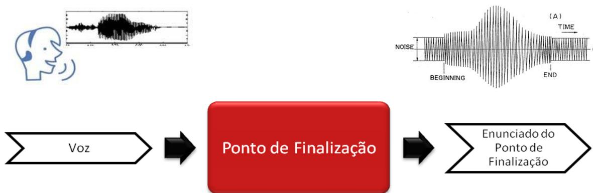
**Figura 4: O ponto de finalização determina onde as ondas de voz começam e terminam**
