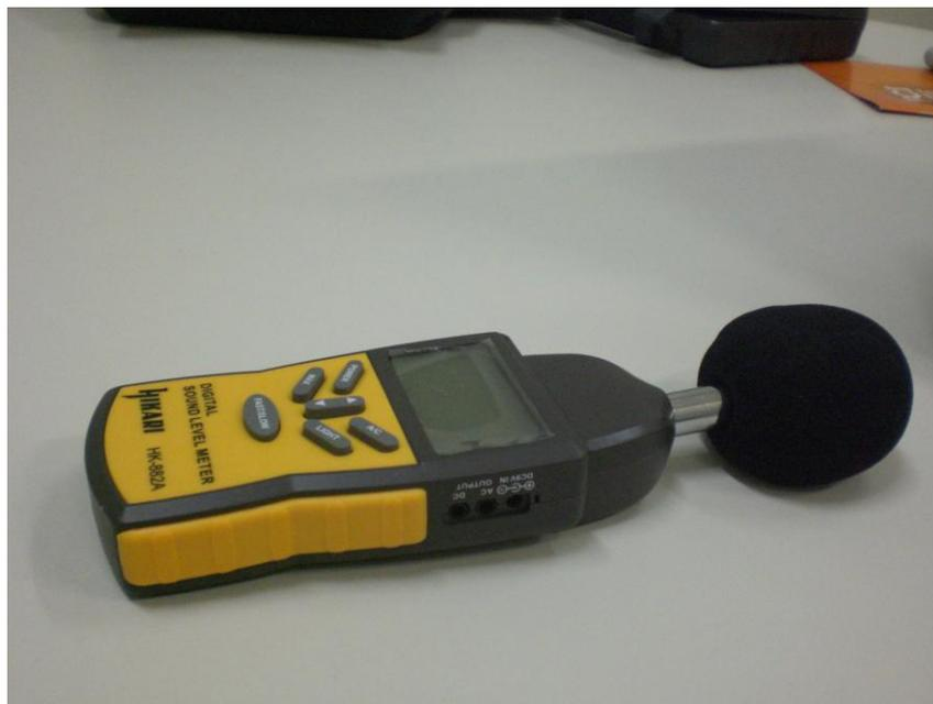
Figura 19: Decibelímetro Utilizado nos Testes. (Fonte: autor)
