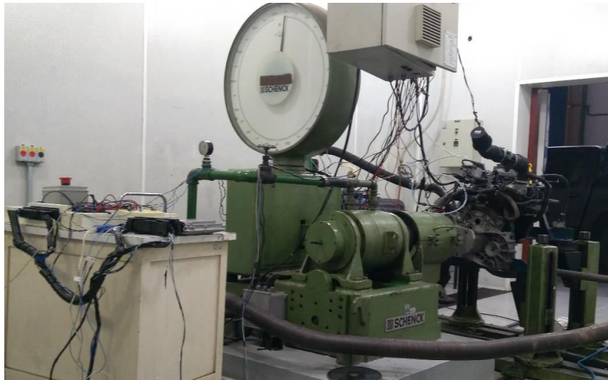
Figura 3.13 – Vista do motor utilizado acoplado ao dinamômetro hidráulico Schenck modelo D360-1E instalado na sala 1 do Laboratório de motores do Instituto de Pesquisas Tecnológicas de São Paulo.
