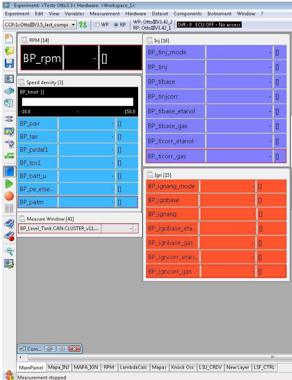
Figura 3.4 - Cenário de experimentos do software INCA com variáveis de medição internas da ECU ETAS/Bosch MEDC17 FlexECU.
