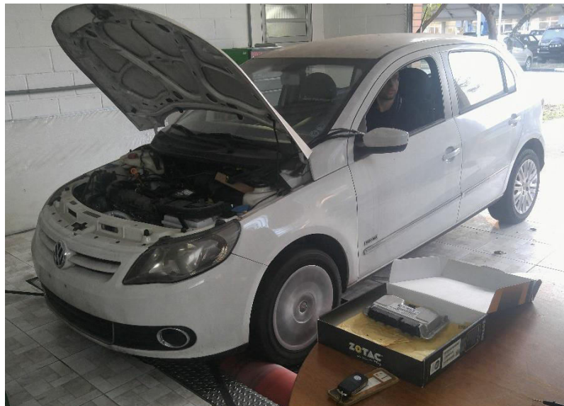
Figura 3.12 – Veículo de testes operando em um dinamômetro de chassi do IEE USP (Instituto de Energia e Ambiente da Universidade de São Paulo).
