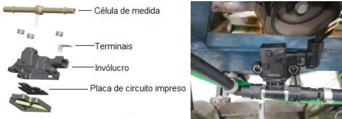
Figura 3.7 – Identificação do dispositivo eletrônico Br-FFS ( Flex-Fuel Sensor ) com calibração brasileira.
