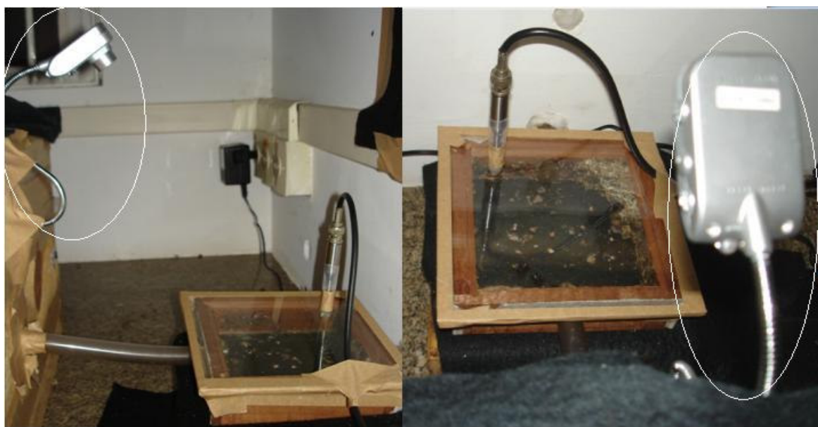
Figura 10. Webcam Clone 11148, circulado de branco, obtendo imagem da área de recrutamento.
