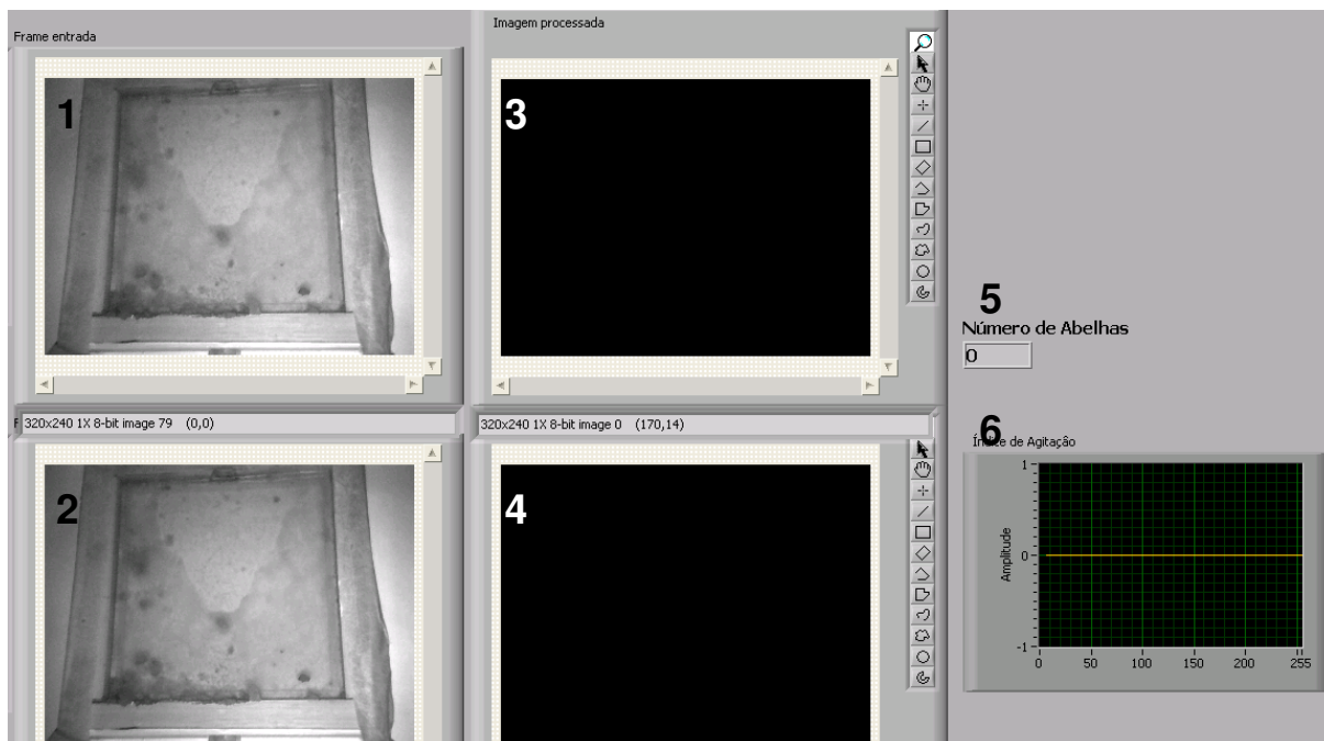
Figura 16. Interface do software. 1) Imagem obtida pela câmera sem abelha na área de recrutamento. 2) Imagem de fundo. 3) Imagem limiarizada sem nenhuma abelha. 4) Comparação do frame atual com o frame anterior. 5) Indicação de ausência de abelha na área de recrutamento. 6) Indicação de ausência de agitação de abelha.
