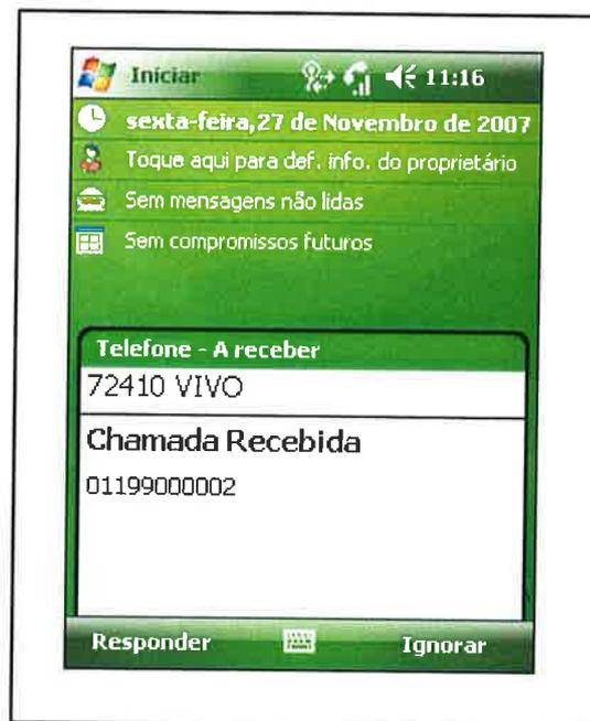
Figura 69 – Captura de tela do *software* do VCC UE recebendo uma chamada CS
