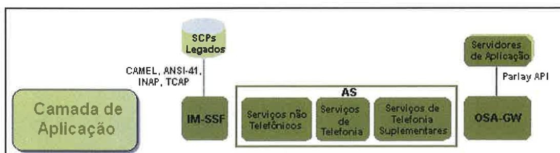
Figura 14 – Componentes da camada de aplicação (BUSHNELL, 2004, adaptado)
