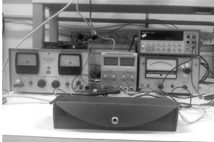
**Figura 4.36** - Montagem do sistema de teste para o fotodiodo de avalanche.
