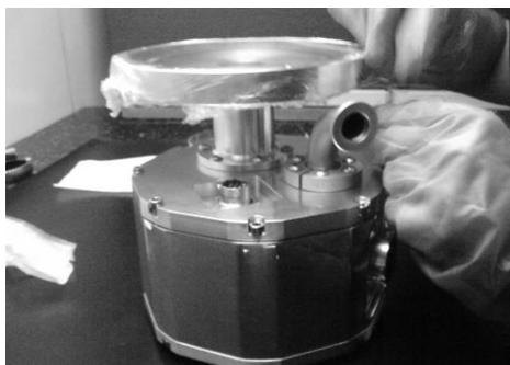
**Figura 4.30** - câmara de teste com nitrogênio líquido
