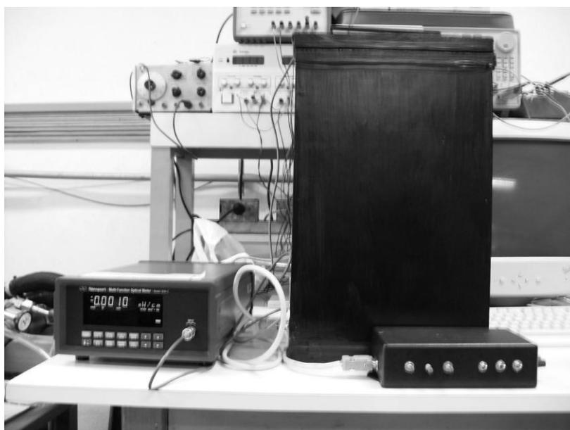
**Figura 4.2** - Montagem para medir a estabilidade da luz constante.
