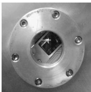
**Figura 4.29** - Vista do EMCCD montado na câmara.
