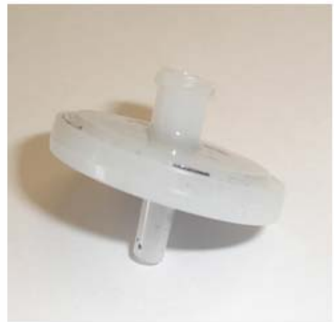
Figura 50(b): Filtro e porta-filtro utilizados na filtragem do PEDOT:PSS.
