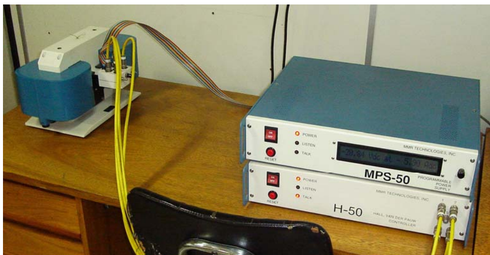
Figura 36: Equipamento de Efeito Hall com os módulos: controlador de circuito elétrico Van der Pauw modelo H-50, fonte de potência programável modelo MPS-50 e os eletroímãs com o porta-amostra ao meio (conectados pelos fios amarelos).
