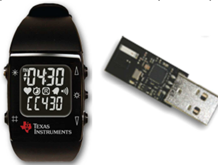
Figura 7 - O relógio e o rádio receptor transmissor USB, compondo a plataforma ez430-Chronos.
