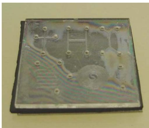
Figura 4.15 - Lâmina soldada com percentual inferior ao esperado
