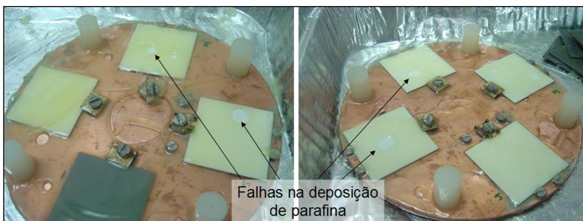
Figura 63 – Diferentes amostras após 2 minutos de processo de deposição de parafina.
