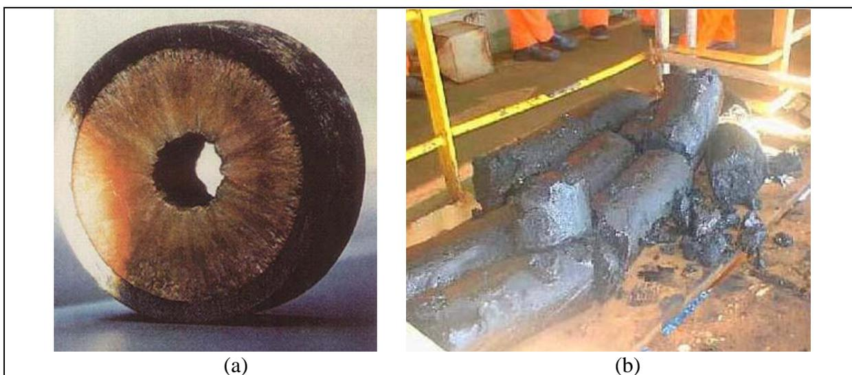
Figura 4 – O problema da deposição de parafina na parede interna de dutos de transporte de petróleo cru. (a) Vista de corte de um duto obstruído; (b) parafina retirada de tubulações.
