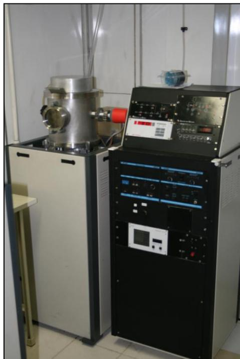
Figura 9 – Equipamento de deposição pela técnica *sputtering*.
