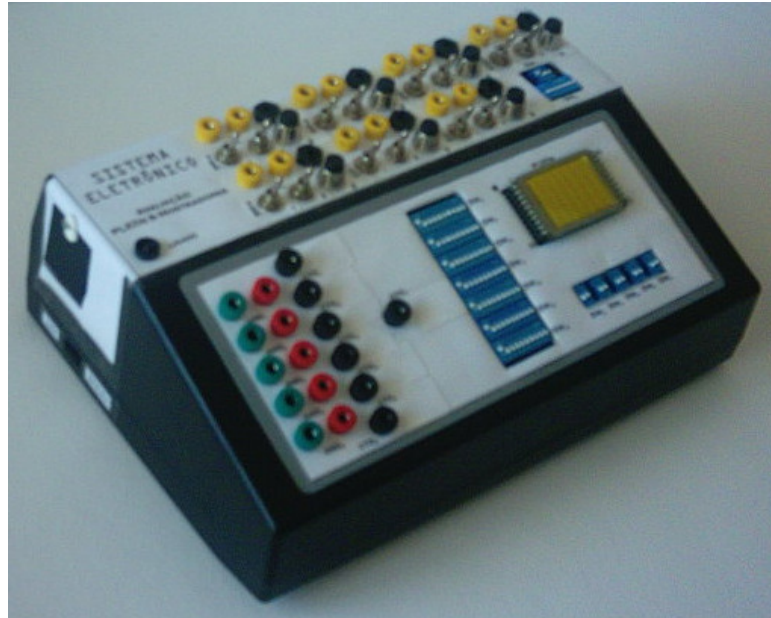
Figura 39 – Sistema Eletrônico de Teste (SET) desenvolvido neste trabalho
