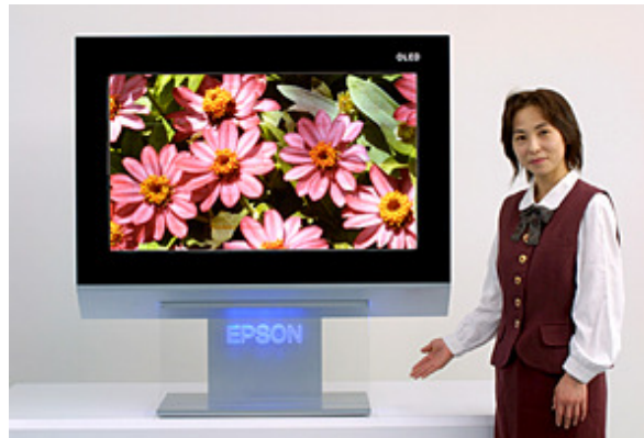
Figura 1 - Tela de 40 polegadas em PLED da Seiko-Epson fabricada por impressão a jato de tinta
