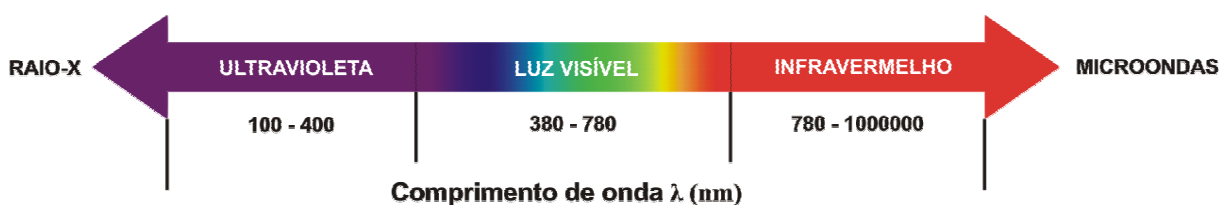
Figura 43 – Organização da luz no espectro eletromagnético: a radiação visível começa em 380nm, ultravioleta, e termina em 780nm, infravermelho
