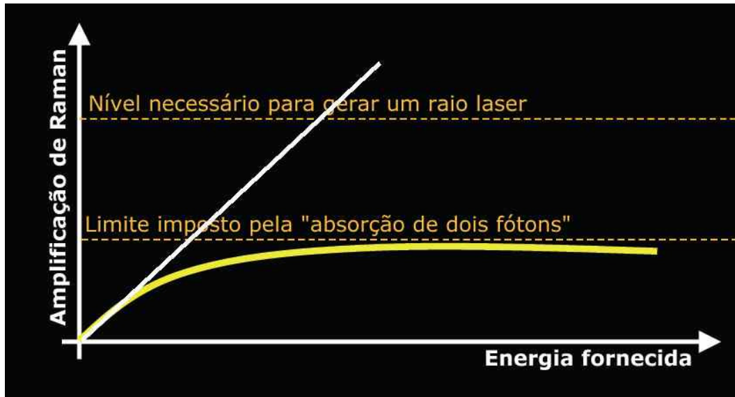
Figura 2.6 Curva que mostra o Limite imposto pelo fenômeno “absorção de dois fótons”.
