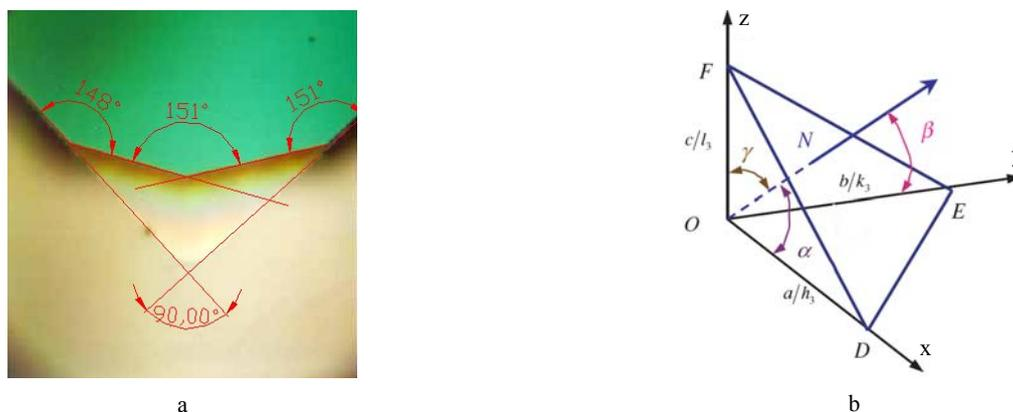
Figura 15 – a) Exemplo de medida dos ângulos das projeções dos planos convexos formados e b) Orientação do plano do cristal de índices de Miller (h,k,l) (CHANG et al., 2005)
