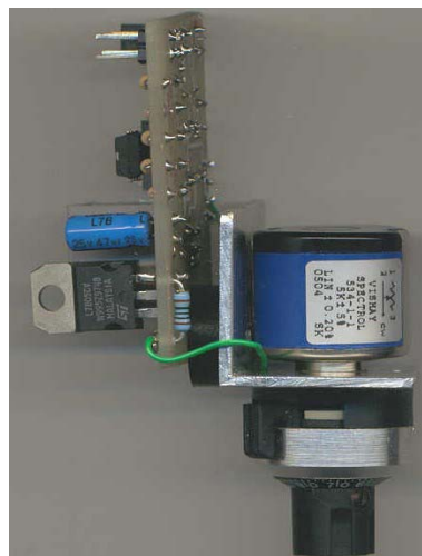
Figura 49: Dispositivo de teste montado com potenciômetro multivoltas e dial graduado
