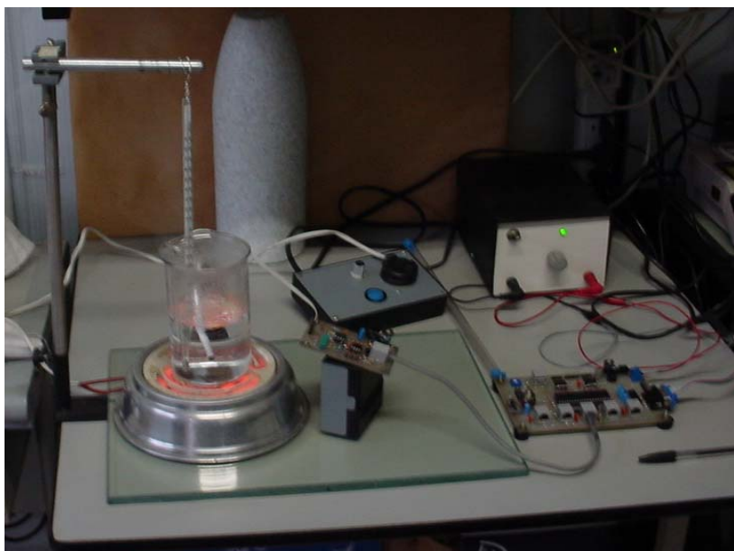
Figura 55: arranjo experimental-2 para medida de temperatura 100^{\circ}\text{C}
