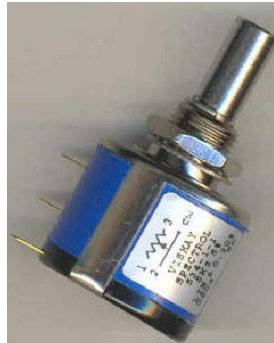
Figura 48: Aspecto físico do potenciômetro de Precisão (multivoltas)
