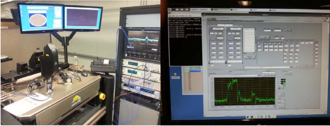
Figura 4.11 (a) Sistema de memória no laboratório do Imec e (b) pulsos gerados no software do LabView.
