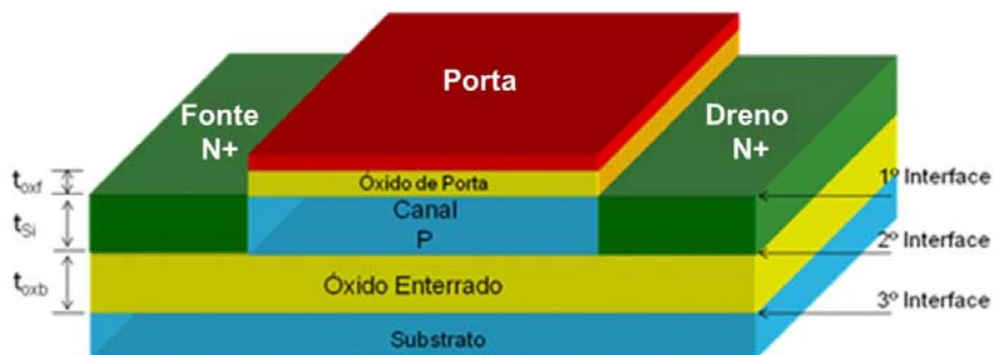
Figura 2.1 Perfil transversal de um SOI MOSFET.
