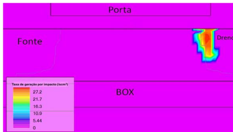
Figura 4.13 Geração de lacunas próxima ao dreno por ionização por impacto durante a escrita do dado '1' na memória 56 .
