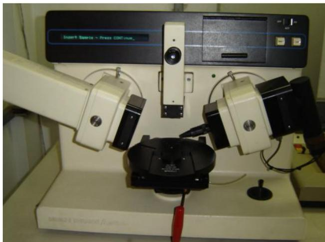
*Figura 3.3: Elipsômetro fabricado pela Rudolph Research Corporation, modelo AutoEL IV MS, do Laboratório de Sistema Integráveis da Escola Politécnica da USP.*
