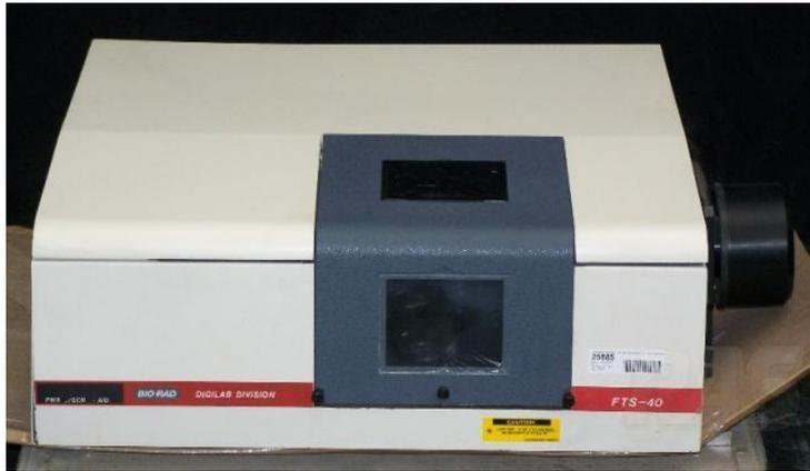
*Figura 3.8: Foto do equipamento Digilab FTS-40 FTIR (BIO-RAD), que se encontra no Laboratório de Microeletrônica (LME) da Escola Politécnica da USP.*
