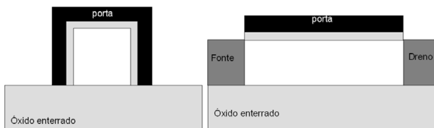
Figura 5.3: Cortes frontal e lateral da estrutura usada nas simulações para estudo da mobilidade efetiva.
