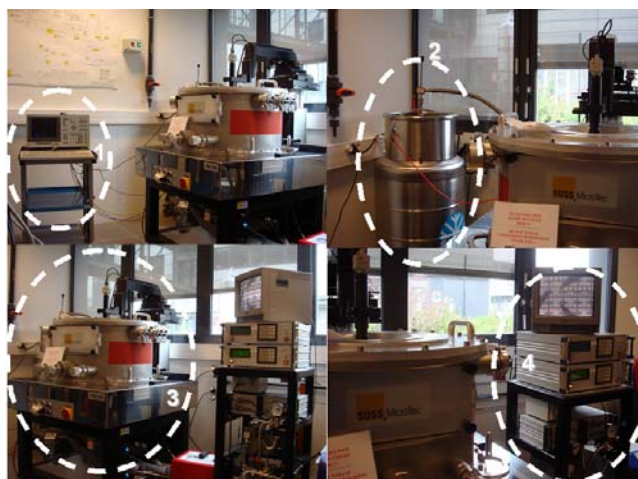
Figura 6.7: Estação criogênica Suss Microtec composto por: 1 – Equipamento HP 4155A; 2 – tanque de nitrogênio líquido; 3 – Estação propriamente dita (câmara de vácuo criogênica de quatro pontas) junto a ela é acoplada uma câmera que permite verificar a posição dos dispositivo através do monitor; 4 – Rack com duas bombas utilizadas pelo circuito de resfriamento, circuito duplo de resistências térmicas que para manter a temperatura do chuck e do interno da câmara, dois blocos de dois captadores de temperatura e o monitor que permite posicionar as pontas sobre o dispositivo, e a bomba que faz o vácuo na câmara.
