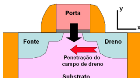
Figura 2.5: Penetração do campo de dreno fazendo com que haja perda do controle de carga pela porta
