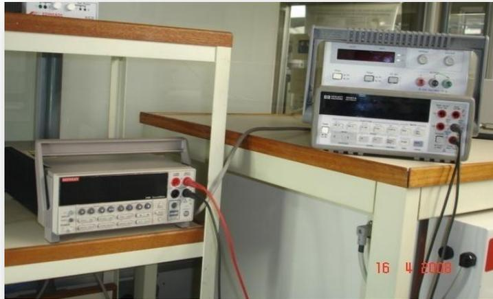
Figura 14: fonte de corrente e multímetro
