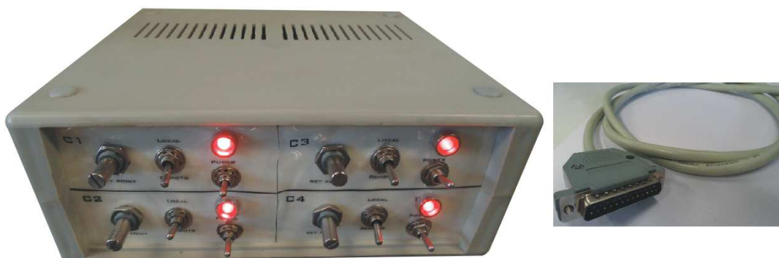
Figura 18 - Módulo de interface fabricado e seu cabo para comunicação com a placa de aquisição.
