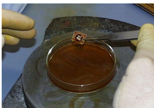
Figura 3.8 – O ácido nítrico fumegante aquecido (> 98% HNO 3 ) dissolve a embalagem sem afetar o chip.
