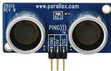
Figura 39. Sensor de ultrassom PING))).
