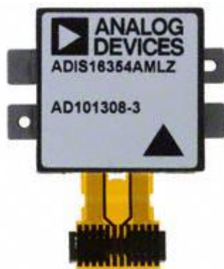
Figura 35. Fotografia do sensor ADIS16354AMLZ.
