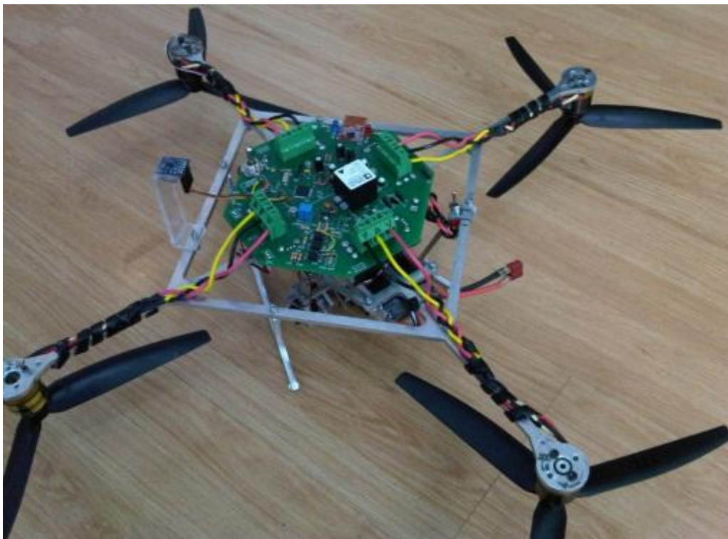
Figura 33. Imagem do UAV concluído.
