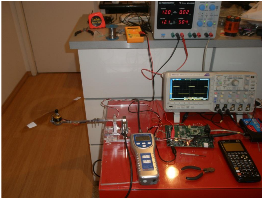
Figura 27. Configuração total do ensaio de empuxo do rotor.
